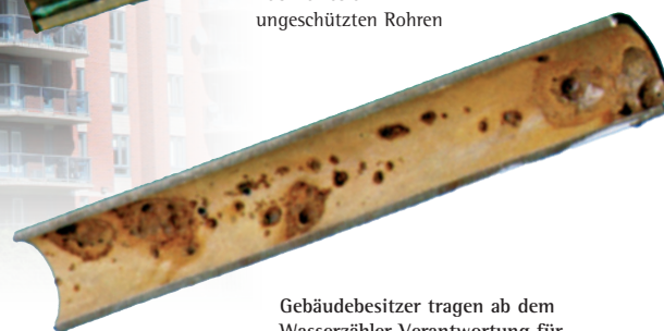
Lochkorrosion in ungeschützten Rohren
